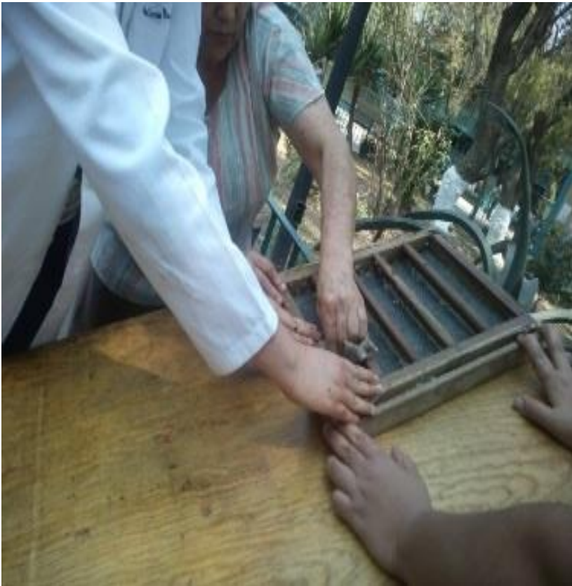
Técnica del bastidor para la elaboración del papel germinador fabricado con cartón, lombricomposta-agrolita
